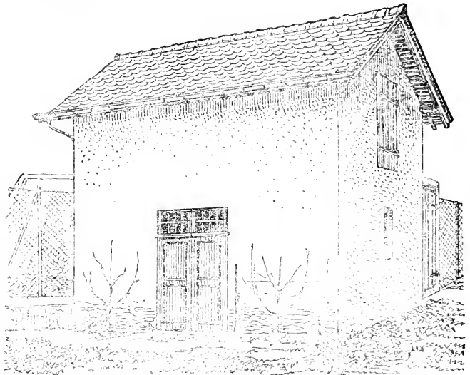
Logette de petit élevage, en béton comprimé dans des banches.
